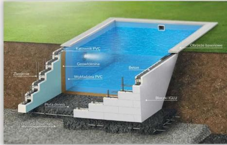
EPS 25 Blöcke (expandiertes Polystyrol mit einer Dichte von 25 kg /m<sup>3</sup>) werden in der Baubranche aufgrund ihrer hervorragenden Wärmedämmeigenschaften, ihres geringen Gewichts und einfacher Montage bekannt.
